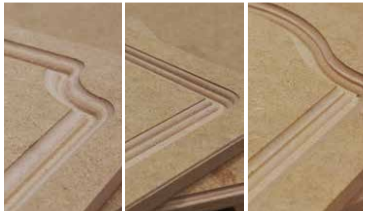
Biseautage avec différentes fraises CNC PREMIUM ST
